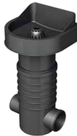
Syöksytorven alle asennettava kaivo, jossa vesitiivis pohjaosa, 2 x 110 liitokset, roiskeuoja, sorapesä ja irrotettava sihtiosa. Teleskooppirakenteen avulla korkeus on säädettävissä.
