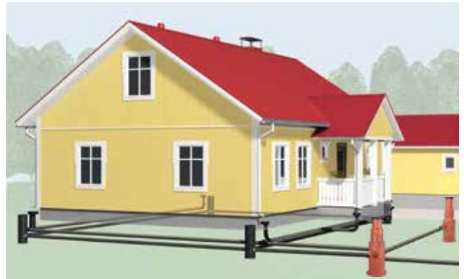
Toimiva salaoja- ja sadevesijärjestelmä pitää talon perustukset kuivina. Salaojakaivot helpottavat järjestelmän huoltamista sen elinkaaren aikana.
